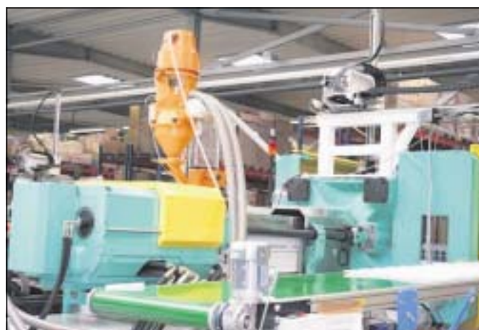
Die Zuhaltkräfte in den Spritzgussautomaten der Fa. Leibe in Grevenbrück reichen von 15 bis zu 250 Tonnen, die produzierten Teile können maximal 630 x 630 mm messen.
